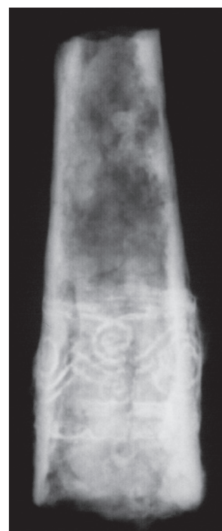
Figura 6.1 i 6.2. La dolla d'una de les puntes de llança que ha patit una greu degradació a causa del desenvolupament de la corrosió. (Xavier Goñi – Servei de Reproducció i Imatge de la Universitat de Lleida.) Gràcies a la radiografia feta al Servei d'Oncologia Radioteràpica de l'Hospital Arnau de Vilanova se'n pot conèixer la decoració damasquinada.
