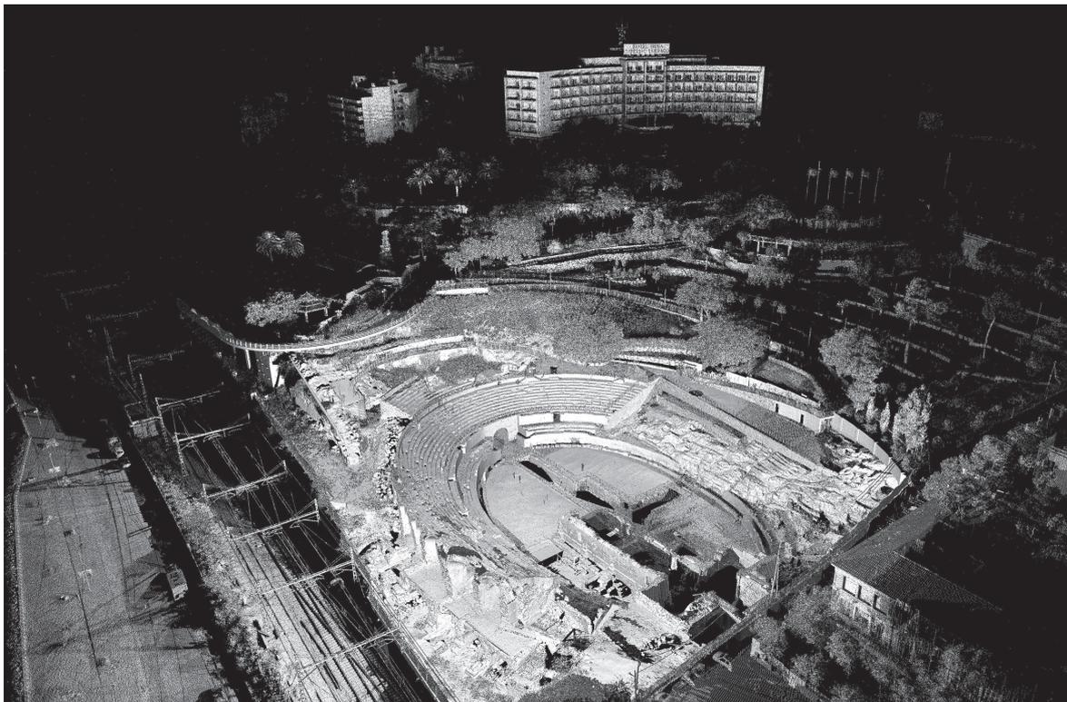
Figura 11. Imagen del escáner láser del anfiteatro de Tarragona. En el levantamiento se documentó, además del objeto del trabajo (el anfiteatro), todo su entorno: las viviendas, la vegetación y la vía ferroviaria (incluida la catenaria). Fuente: ICAC. Unidad de Documentación Gráfica 2013.
