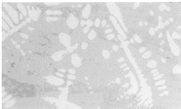
Microfotografía nº 6. Intercrecimiento de cristales de wüstita (amarillo suave) sobre una matriz compacta de fayalita (pardo suave). Luz reflejada, un polarizador, 110x.
