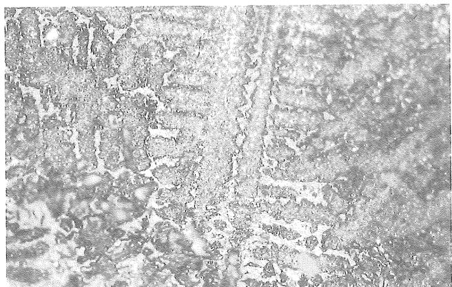
Fig. 10. Detalle metalográfico de un colgante de anilla con apéndice esferoidal de bronce, tomado en este extremo (u.e. 7002; fase III). La presencia de dendritas bien desarrolladas, orientadas en diferentes direcciones permiten identificarlo como un elemento de fundición. (X 400).
